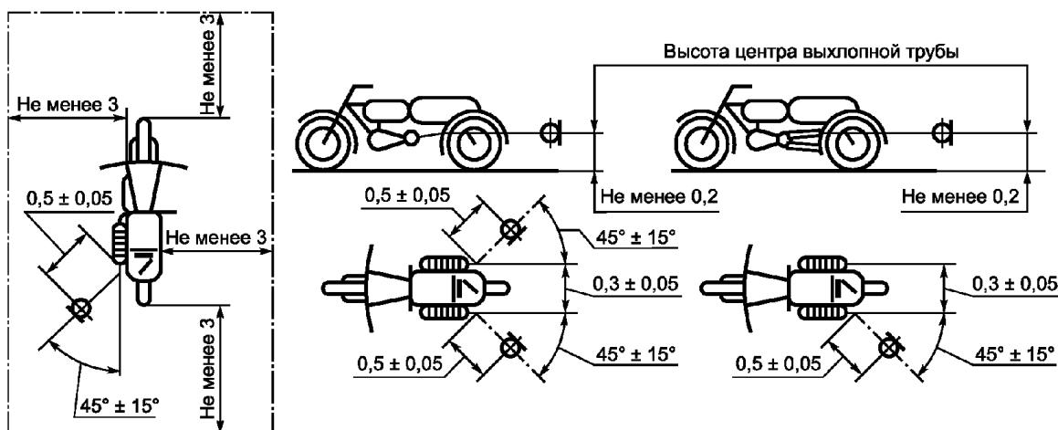
Рисунок K.2 - Расположение микрофона для измерения шума выпуска отработавших газов КТС категорий L
